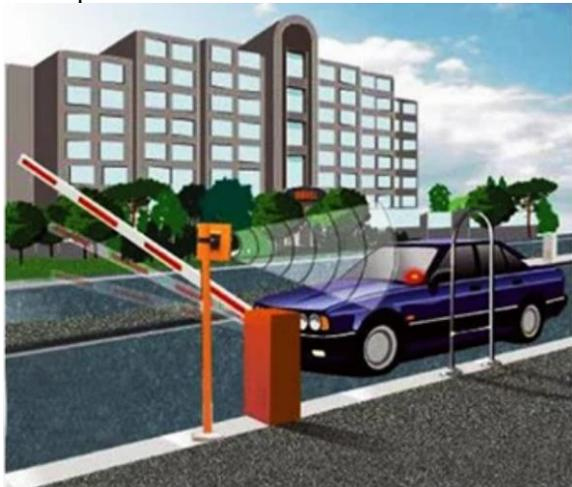
Gambar 4.5 Palang otomatis terbuka setelah Terbaca Oleh Komputer
